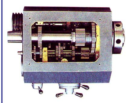
Nella testa motrice monopuleggia il moto viene trasmesso dal motore attraverso una sola puleggia, mediante cinghie trapezoidali. Le diverse velocità del mandrino si ottengono per mezzo di cambi di velocità a ingranaggi, oppure, mediante variatore di velocità.
