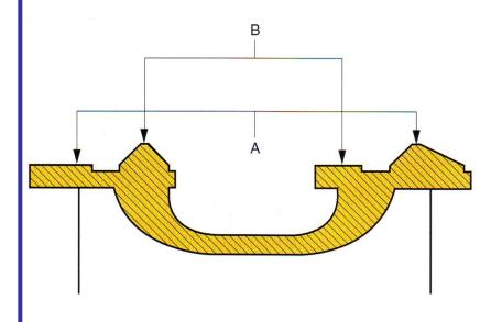
Le guide che si trovano sul bancale servono per lo scorrimento del carro portautensile e della testa (toppo) mobile. Come di vede nella figura si hanno una guida prismatica e una piana per lo scorrimento del carro A e una coppia analoga di guide B per il posizionamento del toppo mobile. Alle guide si richiede un ridotto consumo per usura, ottenibile con un'ottima finitura superficiale e con trattamenti atti a conferire elevata durezza (tempra superficiale a induzione).
